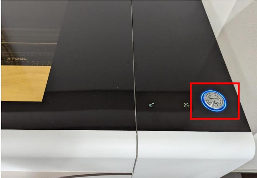
高さが正しく測定できないと正しく加工されません。レーザー出力部品が材料にぶつかり、故障の原因にもなります。そのようなことがあったら、直ちにもう一度同じボタンを押して加工を一時停止してください。
