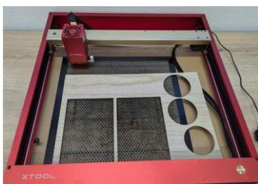
レーザーモジュール側面のスクリューを操作して、高さを調整します。はじめにご利用する際にスタッフから手順をご説明します。
