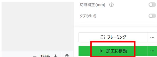
右上の「フレミング」をクリックします。すると、レーザーモジュールが加工エリアの輪郭を移動します。加工エリアが素材からはみだしていないことを確認してください。
